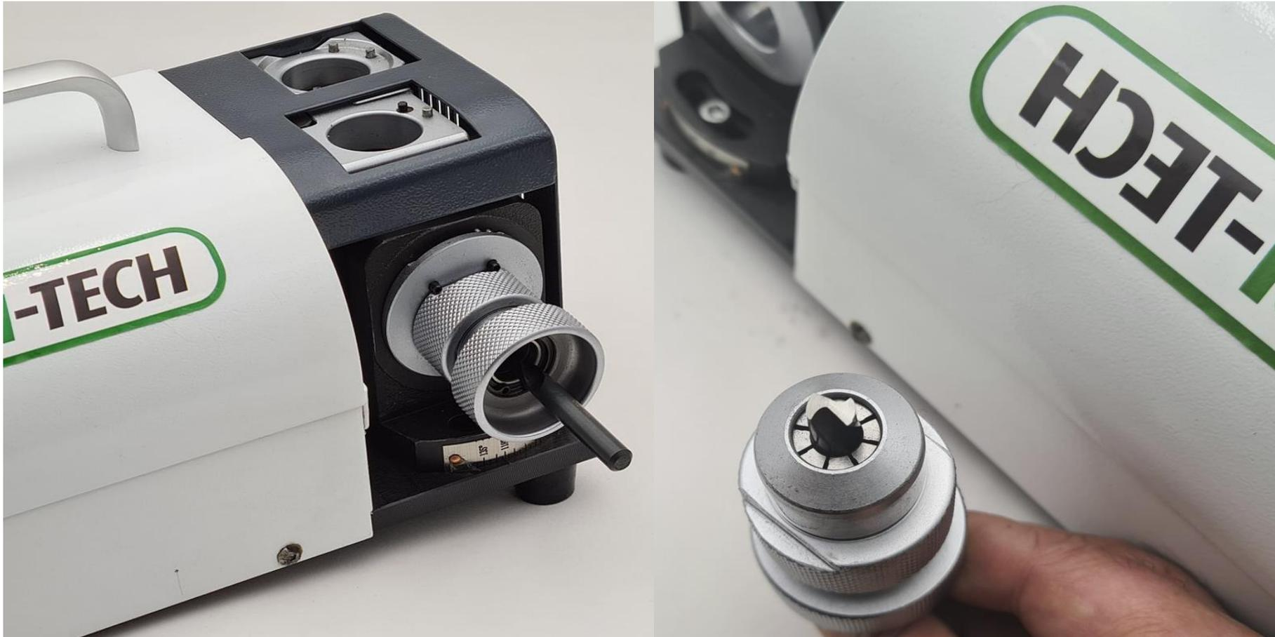
3. Après le démarrage du moteur. Placer le mandrin dans la base de meulage en veillant de positionner le plat du mandrin avec les deux petites goupilles de positionnement (comme indiqué sur l'image).
