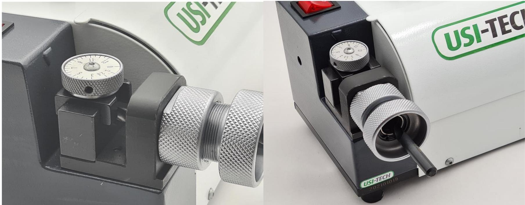
2. Procéder au réglage du doigt de positionnement d'affutage en positionnement grâce à la molette le diamètre d'affutage à effectuer.
